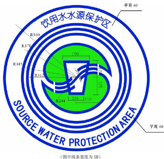
图 4.1-1 饮用水水源保护区图形标尺尺寸及比例
