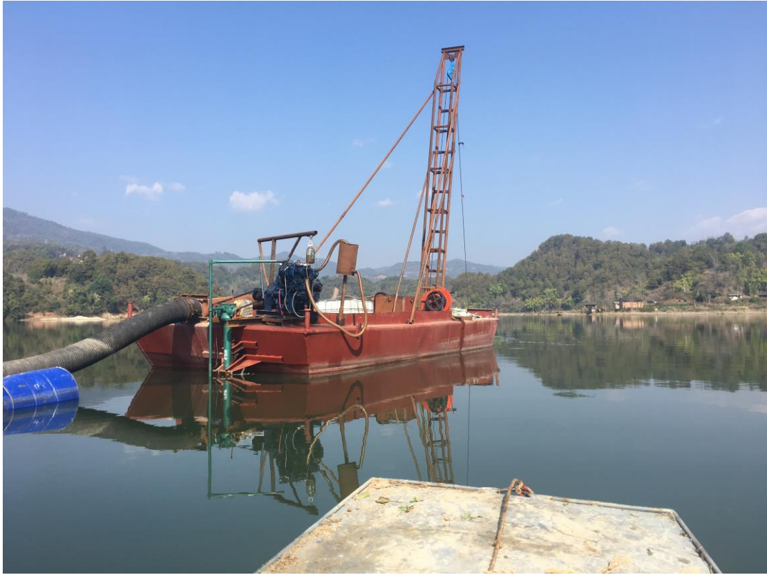
照片 6-10 河道采砂船作业方式
