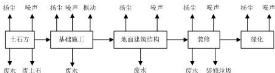
图 5-1 施工期施工流程及产污环节示意图
